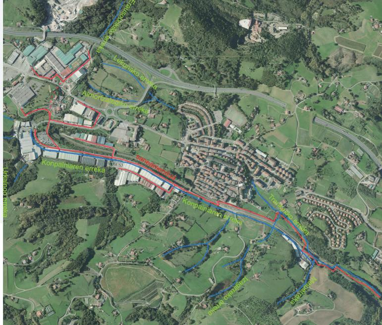
Por lo tanto, las aguas residuales procedentes de un proceso o actividad industrial no podrán ser vertidas por el alcantarillado de pluviales ya que su contenido es vertido a pocos metros en las regatas, contaminándolas y disminuyendo la calidad de sus aguas.
